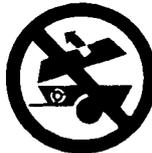
**Maschine nicht mit offenen Gehäuseteilen in Betrieb nehmen.**
