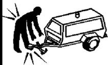
**Colapso da sapata de apoio.
