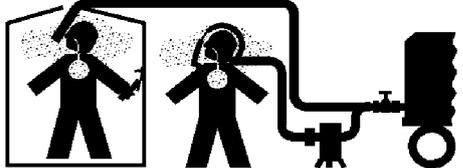
El aire descargado de esta máquina puede contener monóxido de carbono y otros contaminantes que pueden ocasionar graves lesiones e incluso la muerte. No respirar este aire.
