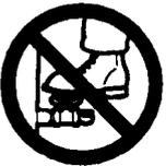
Ne vous tenez pas au-dessus d'une valve d'entretien ou autre pièce du système sous pression.
