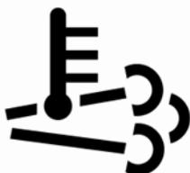
La temperatura del sistema di emissioni del motore può essere alta.
