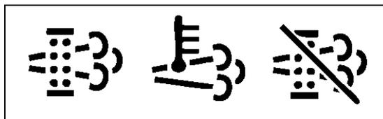
La régénération passive se produit durant la majeure partie du temps d'utilisation de l'équipement. Elle vise à retirer les particules de suie du filtre à particules diesel. Les températures d'échappement restent normales, aucune lampe ne s'allume. Cette opération n'a aucune incidence sur les performances ou le fonctionnement de l'équipement.
