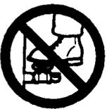
Ne vous tenez pas au-dessus d'une soupape de service ou autre pièce du système sous pression.
