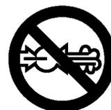
N'ouvrez pas la soupape de service avant d'avoir raccordé le flexible d'air.
