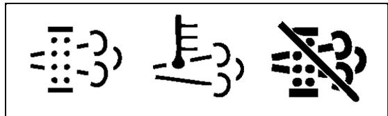
La posizione DISATTIVAZIONE della rigenerazione deve essere selezionata solo se il compressore deve essere utilizzato in un luogo che può essere considerato pericoloso se l'ECM del motore avvia la rigenerazione attiva (temperature di scarico aumentate).
