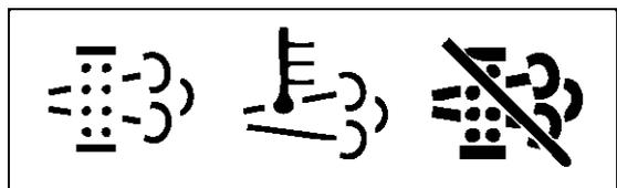
Die DEAKTIVIERTE Stellung der Regeneration darf nur ausgewählt werden, wenn der Kompressor an einem Ort verwendet werden soll, der, wenn das Motorsteuergerät die aktive Regeneration startet (ansteigende Abgastemperaturen), als gefährlich betrachtet wird.
