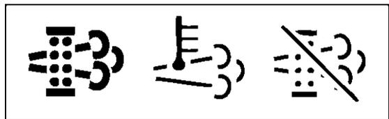
Die DPF-Lampe zeigt dem Bediener an, dass der Filter eine **manuelle aktive Regeneration erfordert, um die Bildung von übermäßigem Ruß zu entfernen**.
