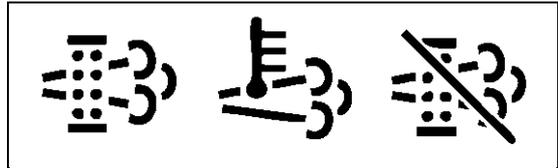
Die passive Regeneration findet fast während des gesamten Betriebs der Vorrichtung statt, um den PM-Ruß aus dem Dieselpartikelfilter zu entfernen. Die Abgastemperaturen bleiben normal und keine Lampen leuchten auf. Es gibt keine Auswirkung auf die Leistung oder den Betrieb der Vorrichtung.
