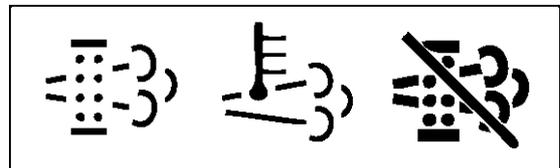
La position de **VERROUILLAGE** de régénération peut être sélectionnée uniquement si l'équipement est utilisé dans un environnement pouvant être considérée comme dangereux en cas d'éventuelle régénération active initiée par le module de commande du moteur (élévation des températures d'échappement).
