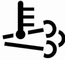
La température du dispositif antipollution du moteur peut être élevée.
