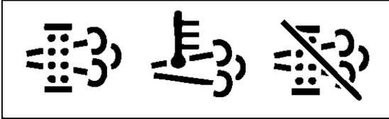
La régénération passive se produit durant la majeure partie du temps d'utilisation de l'équipement. Elle vise à retirer les particules de suie du filtre à particules diesel. Les températures d'échappement restent normales, aucune lampe ne s'allume. Cette opération n'a aucune incidence sur les performances ou le fonctionnement de l'équipement.
