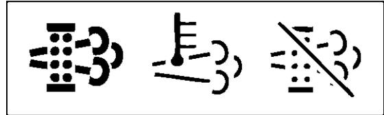
La **lampe DPF** indique à l'opérateur qu'il est nécessaire de procéder à une régénération active manuelle du filtre, afin de retirer l'accumulation des particules de suie.
