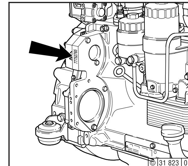
Die Motornummer ist auf dem Kurbelgehäuse sowie auf dem Firmenschild eingestempelt.
