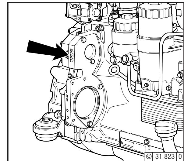
Le numéro du moteur se trouve gravé sur le bloc moteur et figure aussi sur la plaque du constructeur.
