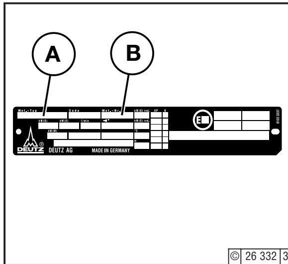
Le type **A**, le numéro du moteur **B** ainsi que les indications de puissance sont gravés sur la plaque du constructeur.
