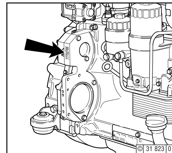
Номер двигателя **B** выбит на картере **D**, а также на фирменной табличке.
