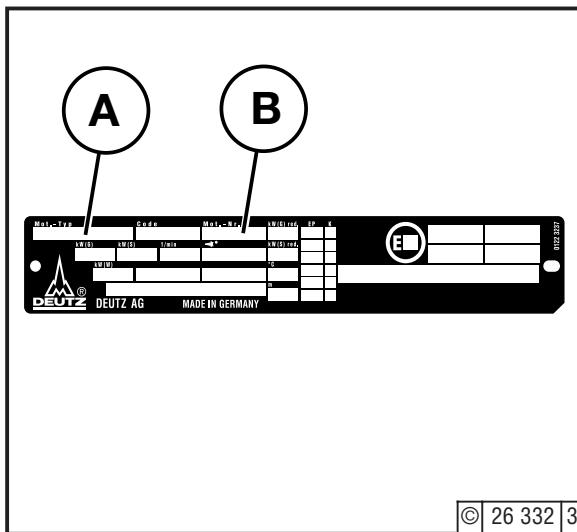
Конструктивное исполнение **A**, номер двигателя **B**, а также рабочие характеристики, указаны на Фирменной табличке. В заказах на запасные части должны указываться модель и номер двигателя.
