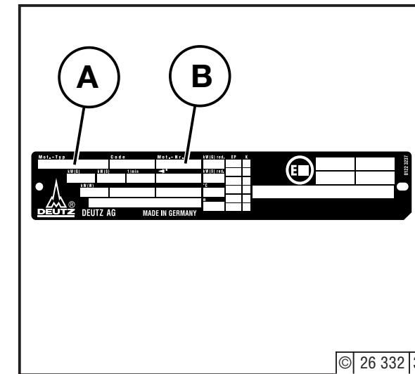
**A** يكون كل من النمط التصميمي للمحرك ورقم المحرك **B** ، وكذلك بيانات قدرة المحرك ، مدموعة على لوحة الطرز للمحرك. ويتحتم ذكر النمط التصميمي للمحرك وكذلك رقم المحرك لدى كل طلب توريد لقطع غيار المحرك .
