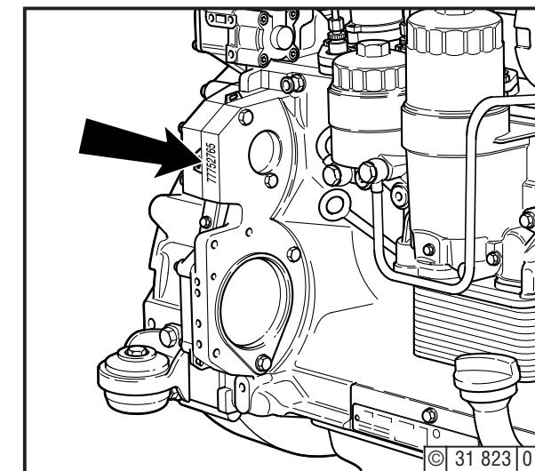
Numer silnika jest odcisknięty na kadłubie silnika oraz na tabliczce firmowej.
