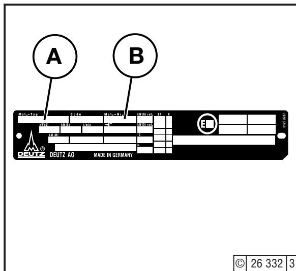
O modelo **A**, o número do motor **B** e os dados de potência encontram-se gravados na placa do fabricante. Quando da aquisição de peças sobresselentes deverão ser indicados o modelo e o número do motor.
