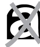
используемые в этом двигателе уплотнения могут содержать асбест. При проведении ремонтных работ обращайте внимание на промакрированные буквой „а“ запасные части.
