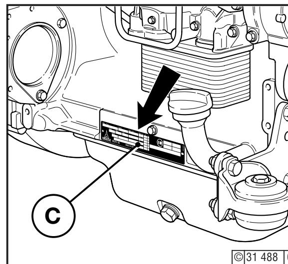
La placa del fabricante **C** va fijada en el cárter.
