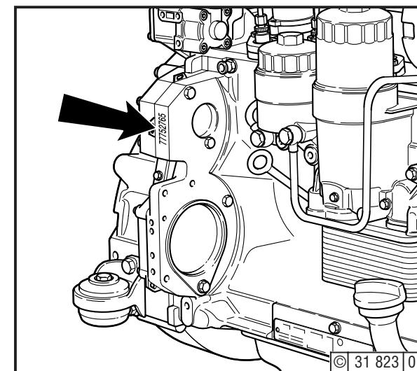
El No. de motor va estampado en el cárter y en la placa del fabricante.
