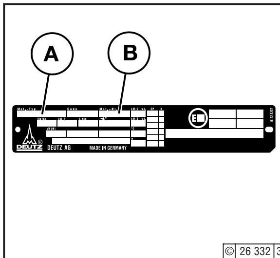
El tipo **A**, el No. de motor **B** así como los datos de potencia van estampados en la placa del fabricante. El tipo y el No. de motor se han de indicar en los pedidos de repuestos.
